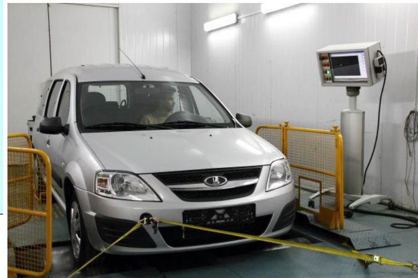
Испытания АТС до 3,5 т (Правило ЕЭК ООН №83)
