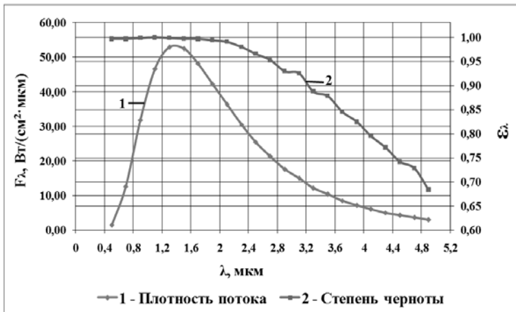
Рис. 2. Спектральное распределение плотности потока и спектральная зависимость степени черноты от длины волны при угле п.к.в. \varphi = 15^\circ , T = 2100 \text{ K} , P = 8,8 \text{ МПа}
