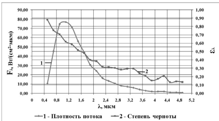
Рис. 4. Спектральное распределение плотности потока и спектральная зависимость степени черноты от длины волны при угле п.к.в. \varphi = 15^\circ , T = 2500\text{ K} , P = 9,2\text{ МПа}
