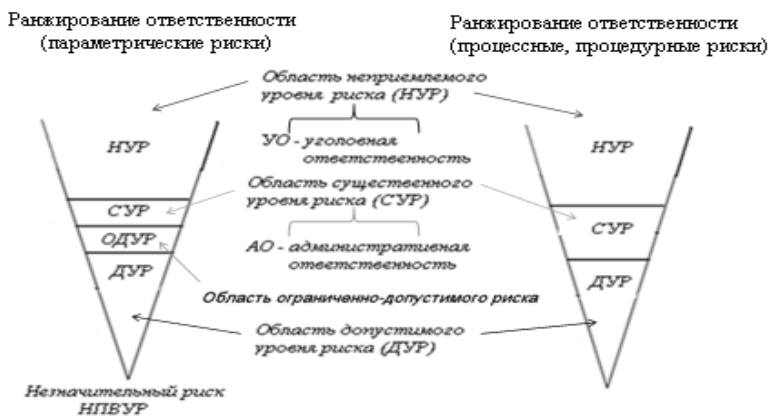
Рис. 11. Установление областей ответственности при нарушении безопасности полетов
