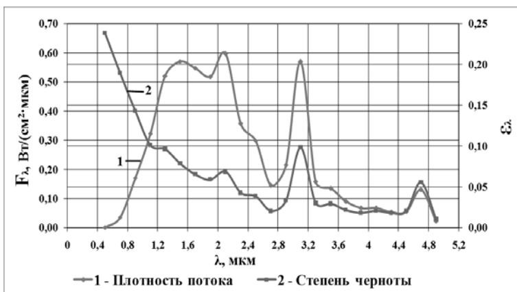
Рис. 5. Спектральное распределение плотности потока и спектральная зависимость степени черноты от длины волны при угле п.к.в. \varphi = 100^\circ , T = 1470\text{ K} , P = 0,9\text{ МПа}
