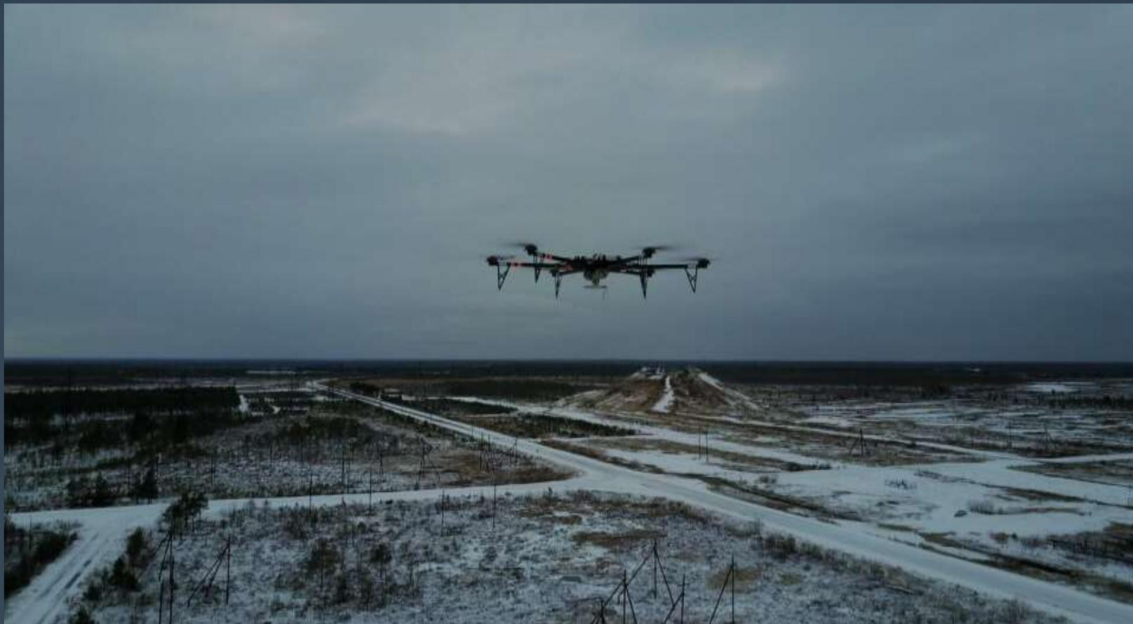
Мультикоптер разрабатывали специально для этого полета. Грузом стал запорный клапан газовой арматуры, весом 12,8 кг. Дальность полета – 15 км
