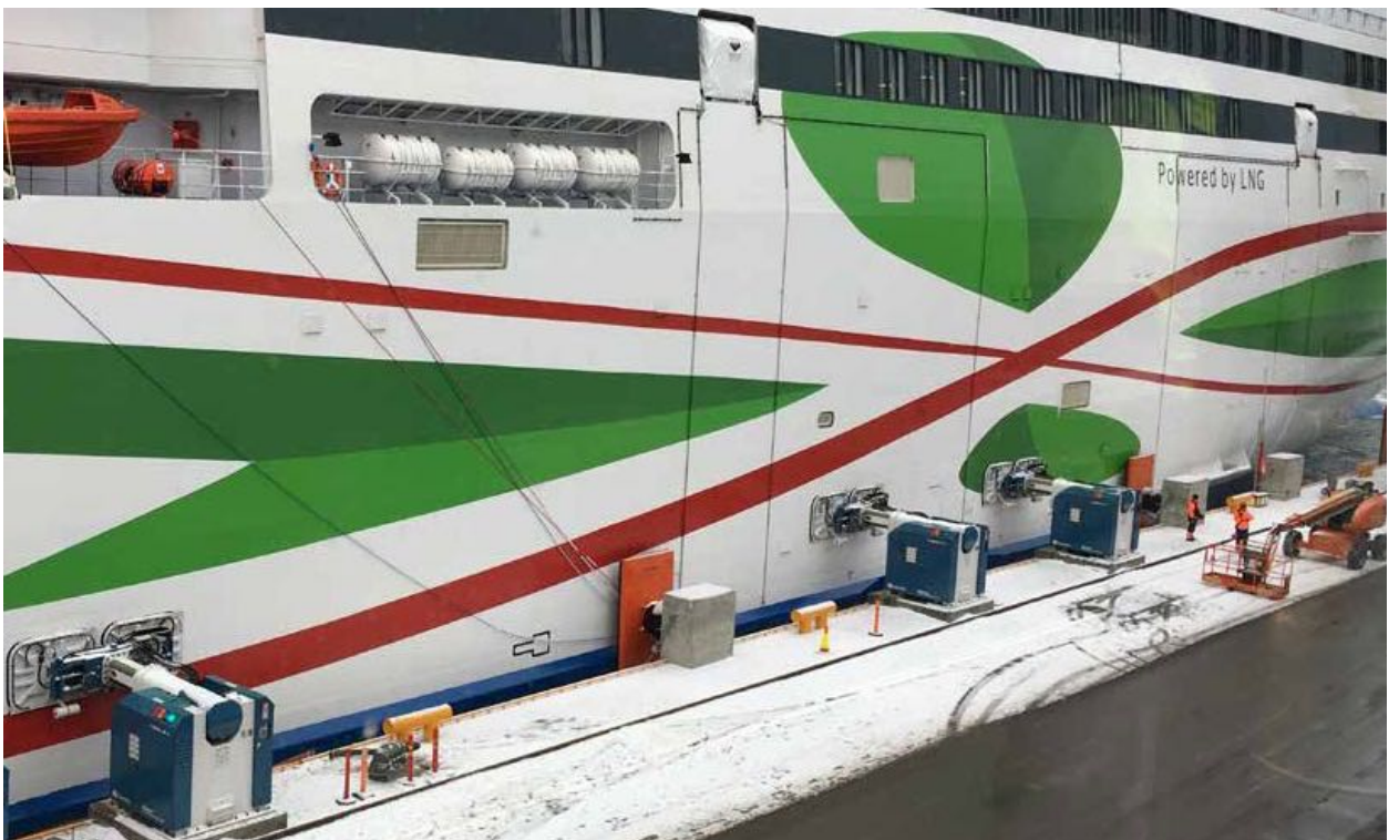
Система автошвартовки Savotec (Швейцария) Фото из проспекта фирмы Savotec
