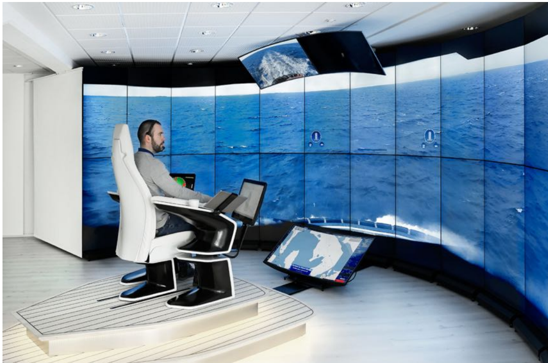
Система удалённого управления судном Rolls-Royce. Фото Rolls-Royce, flickr.com
