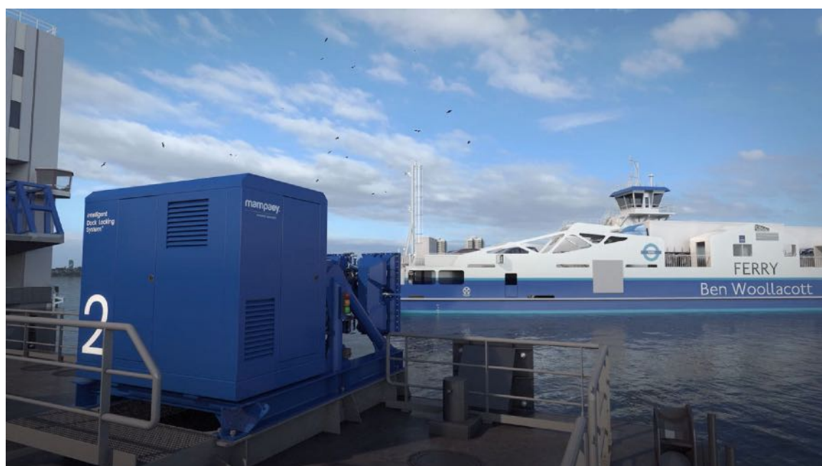
Система магнитной автошвартовки Матраеу (Нидерланды) Фото сайта https://www.goudsmitmagnets.com/ru/announcements/news/ferry-in-London-moors-magnetically
