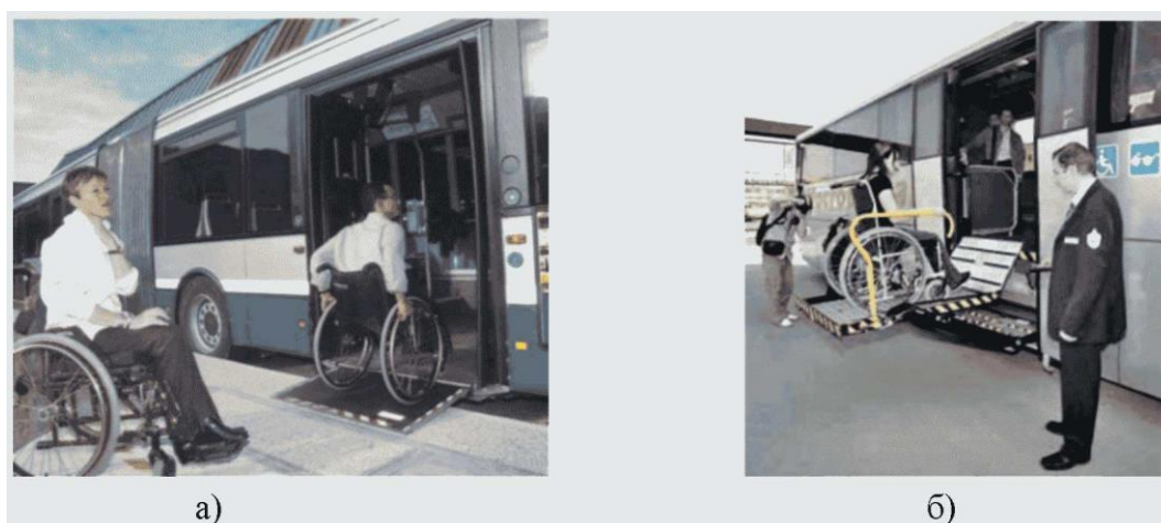
Рисунок 11 – Примеры применения механической (а) и автоматической (б) аппарели автобуса на посадочной площадке в габаритах места посадки инвалидов
